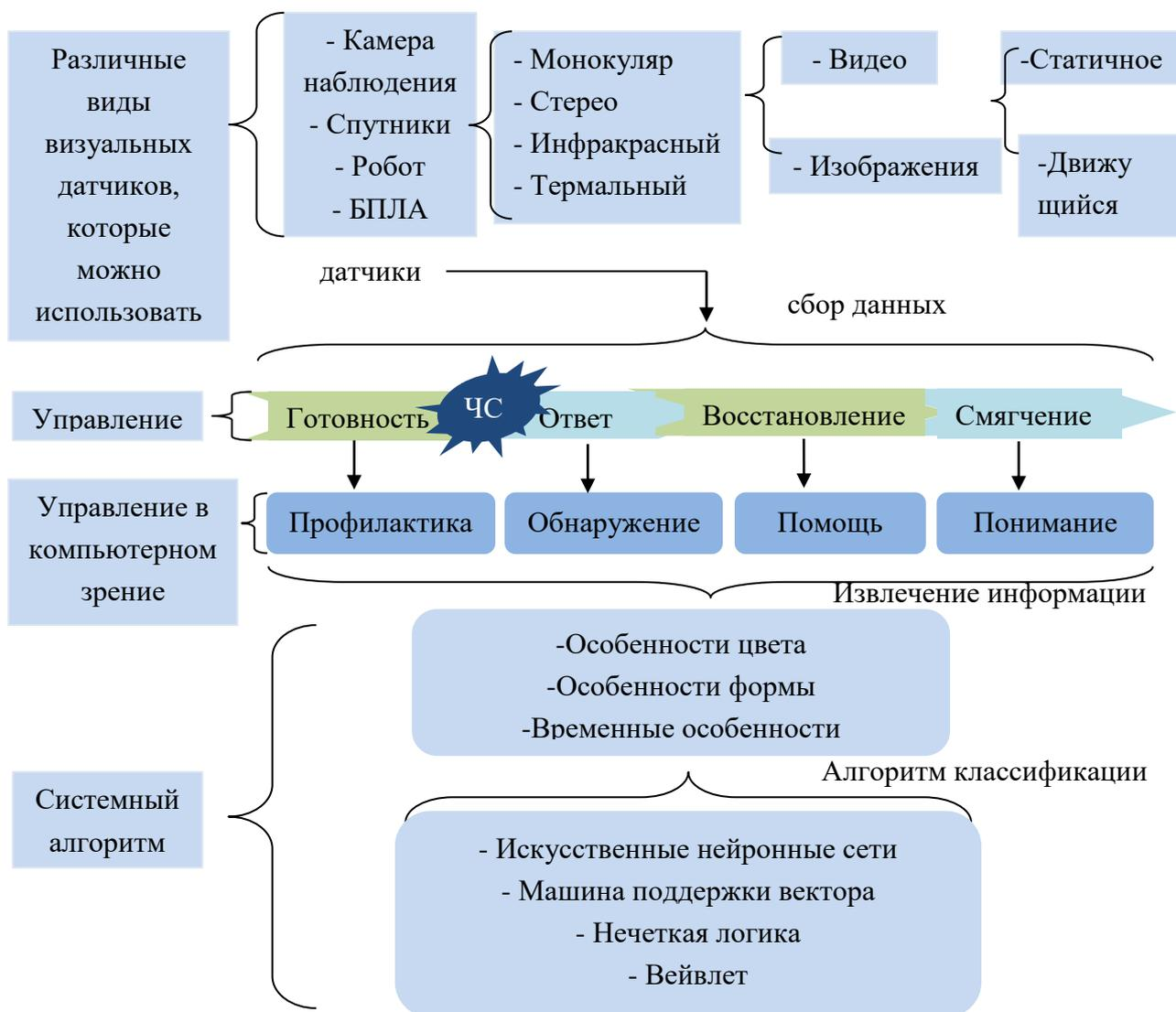
Схема 1 – Алгоритмы выделения и классификации признаков
