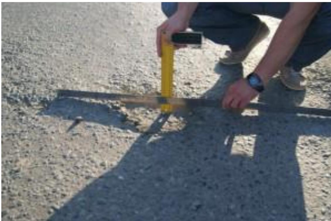
Рисунок 19 - Измерения дефектов дороги
