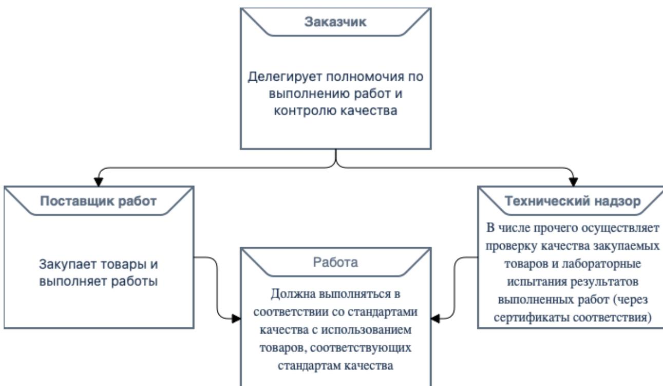
Рисунок 2.18 – Схема обеспечения качества выполняемых работ
