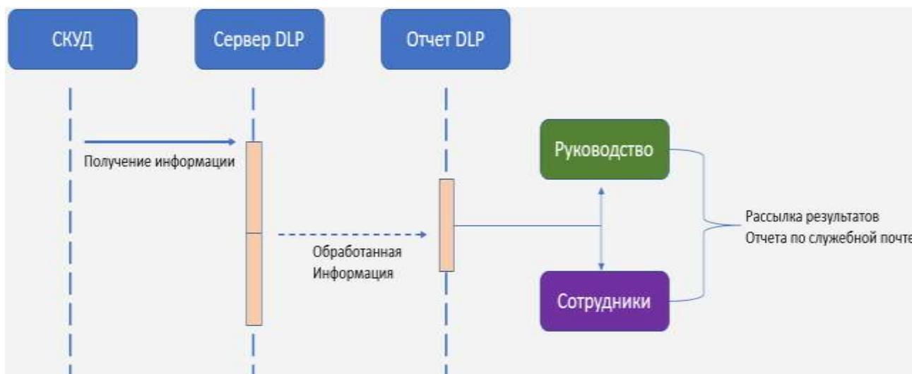
Рисунок 11 – схема интеграции DLP-системы со СКУД.
