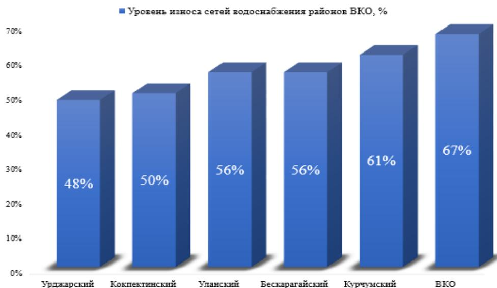
Рисунок 11 – Износ сетей водоснабжения ВКО
